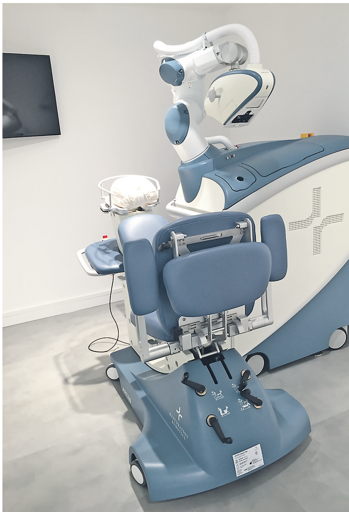
Abb. 1: Das FUE-Robotersystem zur Entnahme der „follicular units“ besteht aus einem verstellbaren Patientenstuhl, der Entnahmeeinheit mit Roboterarm, Kontrollmonitor für den Arzt, Fernsteuerung und Computerarbeitsplatz. © F.Neidel
